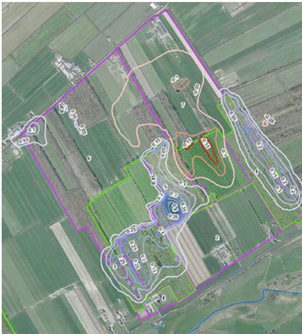
Figuur 12. Effect van de hydrologische maatregelen op Kolland op de grondwaterstand in gemiddelde voorjaars (GVG) situatie. Bron: hoogheemraadschap 'De Stichtse Rijnlanden'.
